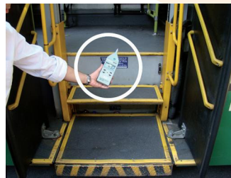
Dispositivo emissor de sinal sonoro na parte externa do veículo com pressão de 55 dB(A) medidos a 1000 mm acionado em conjunto com a plataforma
