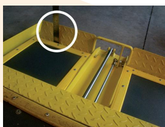
Anteparo frontal de acionamento automático com altura mínima de 70 mm
