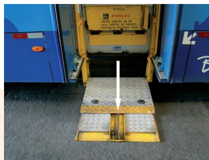
Dispositivo limitando a carga contra o solo que deve se limitar ao peso próprio da plataforma somado à carga de trabalho
