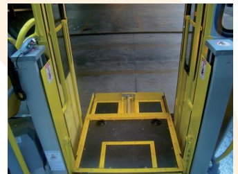
Dispositivo de acionamento da plataforma somente após habilitação da porta acessível
