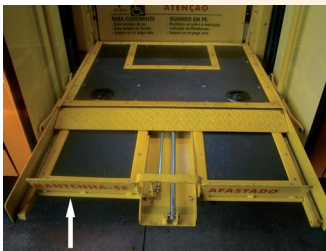
Dispositivo para evitar descida ou queda repentina em caso de falha
