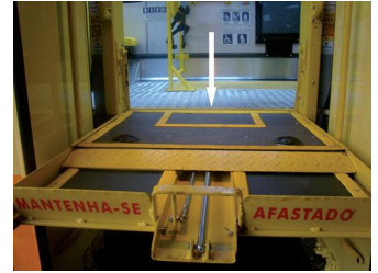
Dispositivo de fim de curso de subida limitando a altura de acesso
